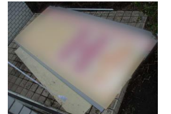
←パネルの変形、ズレ、破損の他、パネルの押さえ枠が変形し落下する場合も。
