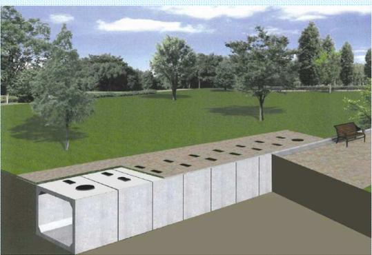
地下にコンクリート製の便槽を埋設します。日常は表面にマンホール蓋だけが見えている状態です。
