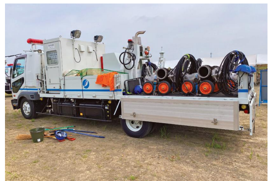
既存の排水ポンプ車
