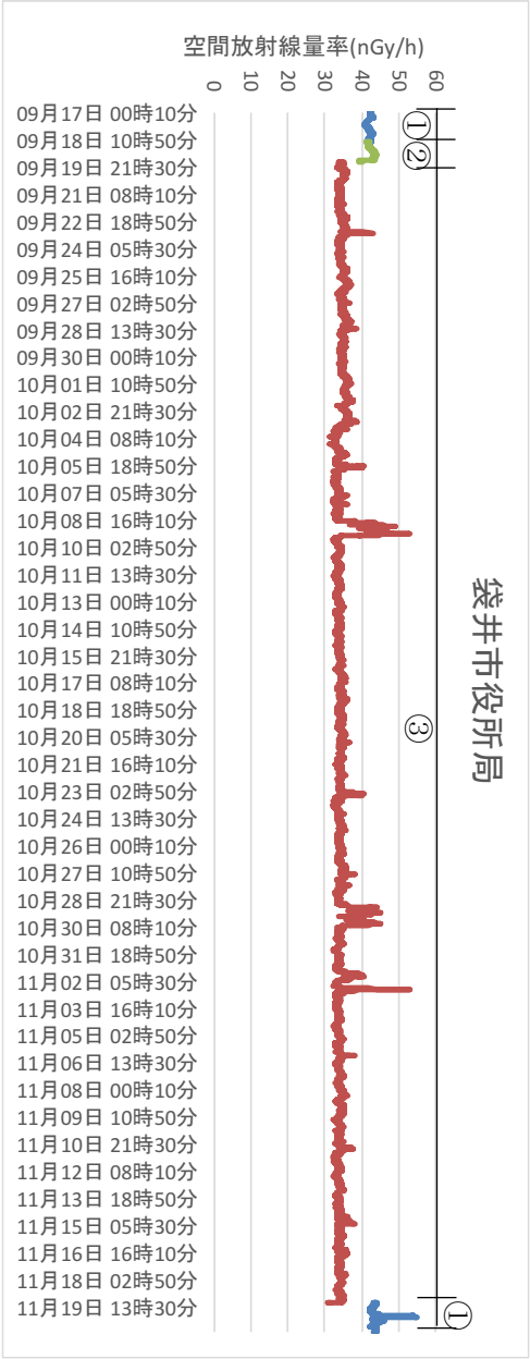
①：固定型測定器（テレメータ収集値） ②：測定器記録計の指示値 1) ③：可搬型MP 注1) 子局装置故障発生から可搬型MP設置までの間の線量率は現地測定器のデータを回収し、2分値から10分値を演算した（測定器記録計の指示値）。
