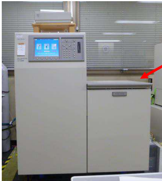
液体シンチレーションカウンタ
