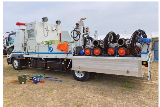
既存の排水ポンプ車
