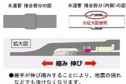
【耐震型継手（接合部分）の構造】
