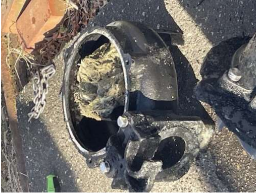
Máy bơm role bị tắc nghẽn do rác.
