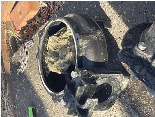
Entupimento da Bomba automática pelo lixo (Moradia habitacional Sumiredai Fevereiro/2024)
