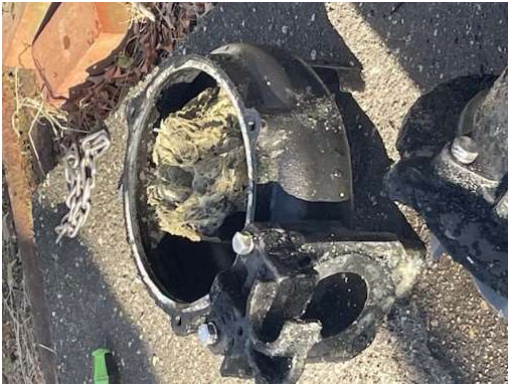
ごみで中継ポンプが詰りました (すみれ台住宅団地 R6.2)
