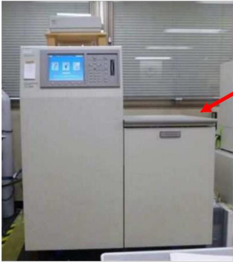
液体シンチレーションカウンタ
