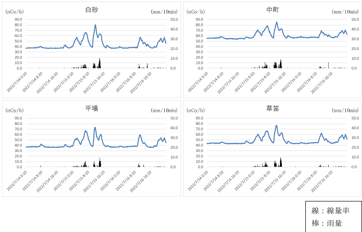
図2 空間放射線量率及び雨量の時系列変化（旧監視センターの近隣MS）
