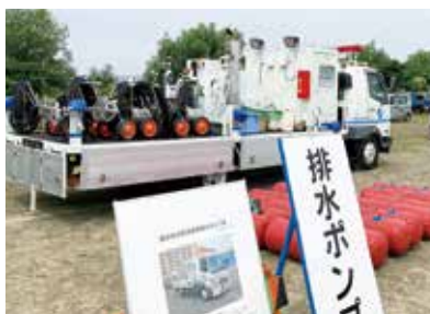
焼津市総合水防訓練時に展示された水防活動用排水ポンプ車
