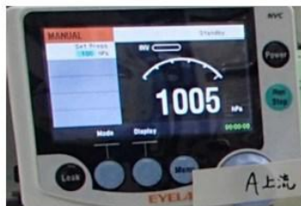
図2 下流側ニードルバルブ操作時の捕集カラム1段目付近圧力
