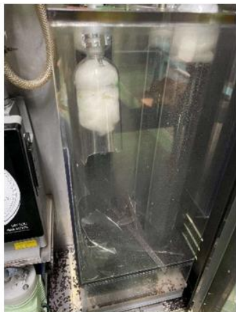
写真1 カラムの破損状況
