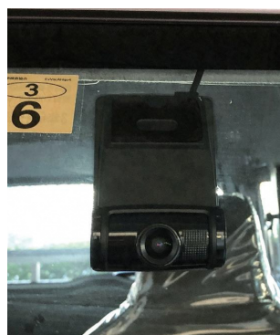
公用車に設置された ドライブレコーダー
