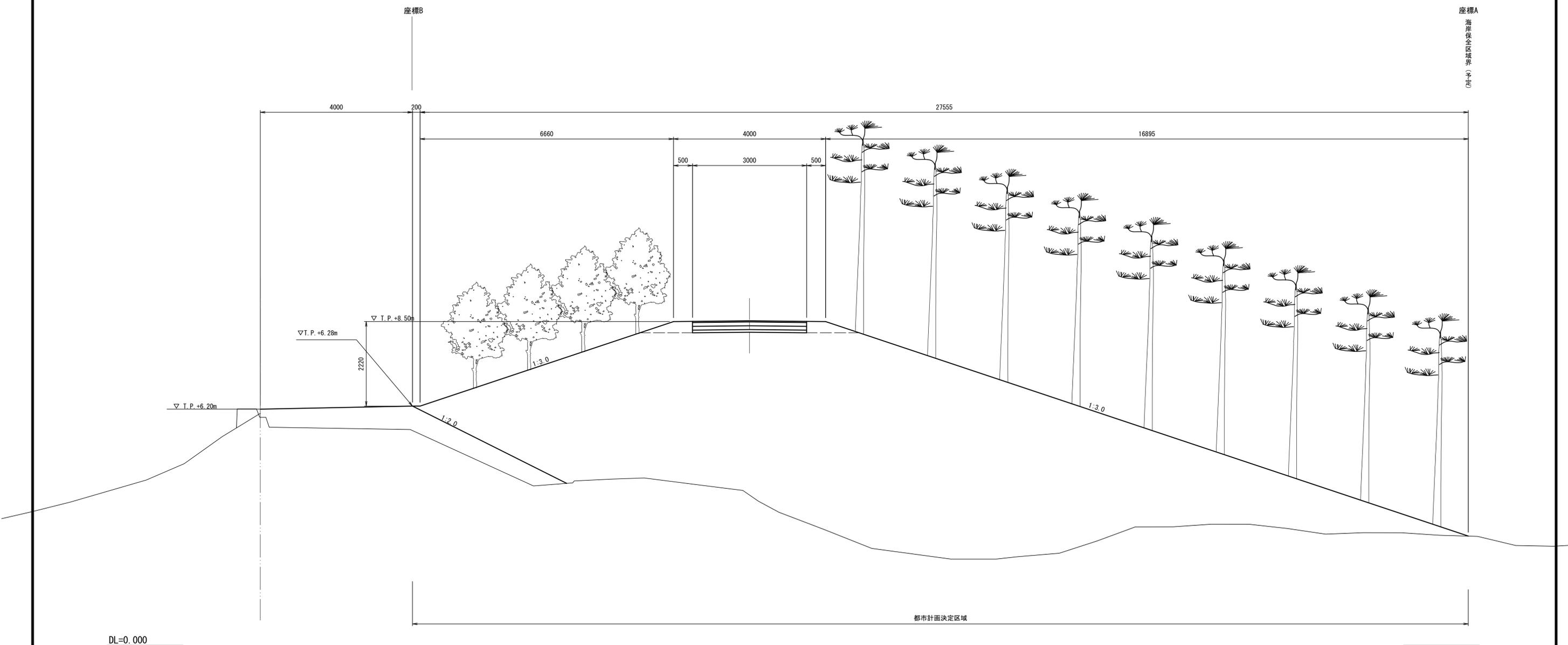
座標A：海岸堤防法肩から、平場0.2m、高さT.P.+8.5mまで勾配 1:3.0、天端幅4m、勾配 1:3.0の盛土の陸側法尻
