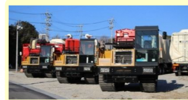
㊅可搬型取水ポンプ車
