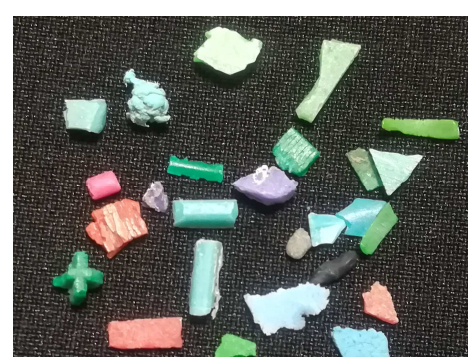
一般に5mm以下の微細なプラスチック類をマイクロプラスチックという
